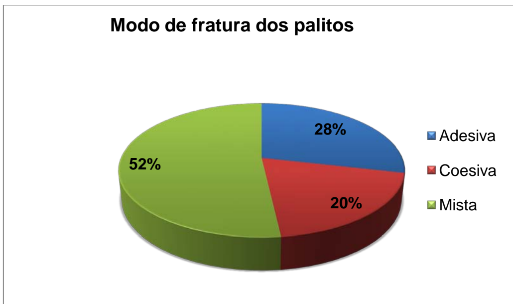
Gráfico 1: Classificação geral do modo de fratura dos corpos de prova
